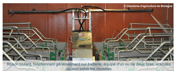
Robot roulant, fonctionnant généralement sur batterie, équipé d'un ou de deux bras, articulés ou non selon les modèles
